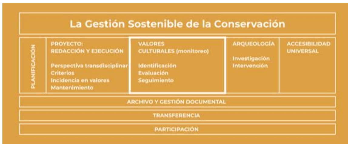
FIGURA 1. METODOLOGÍA Y FASES DE TRABAJO PARA UNA GESTIÓN SOSTENIBLE DE LA CONSERVACIÓN
